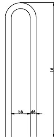
Die Länge der Zulagebewehrung kann um den Faktor 0,7 verringert werden wenn der Steckbügel mit einem Winkelhaken ausgebildet wird.
