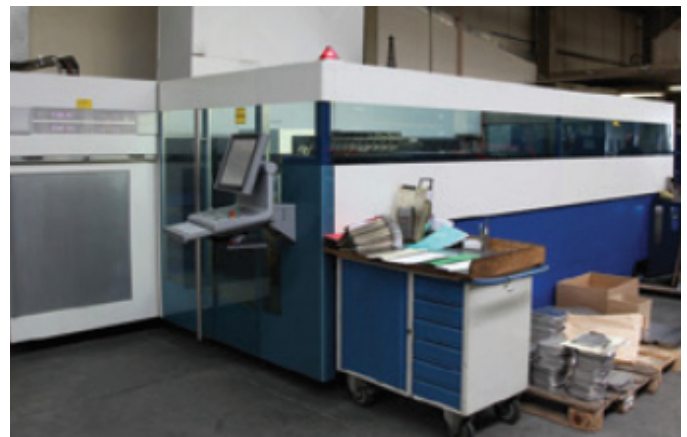
Laserschneidemaschine für Fassadenanker u.a.
